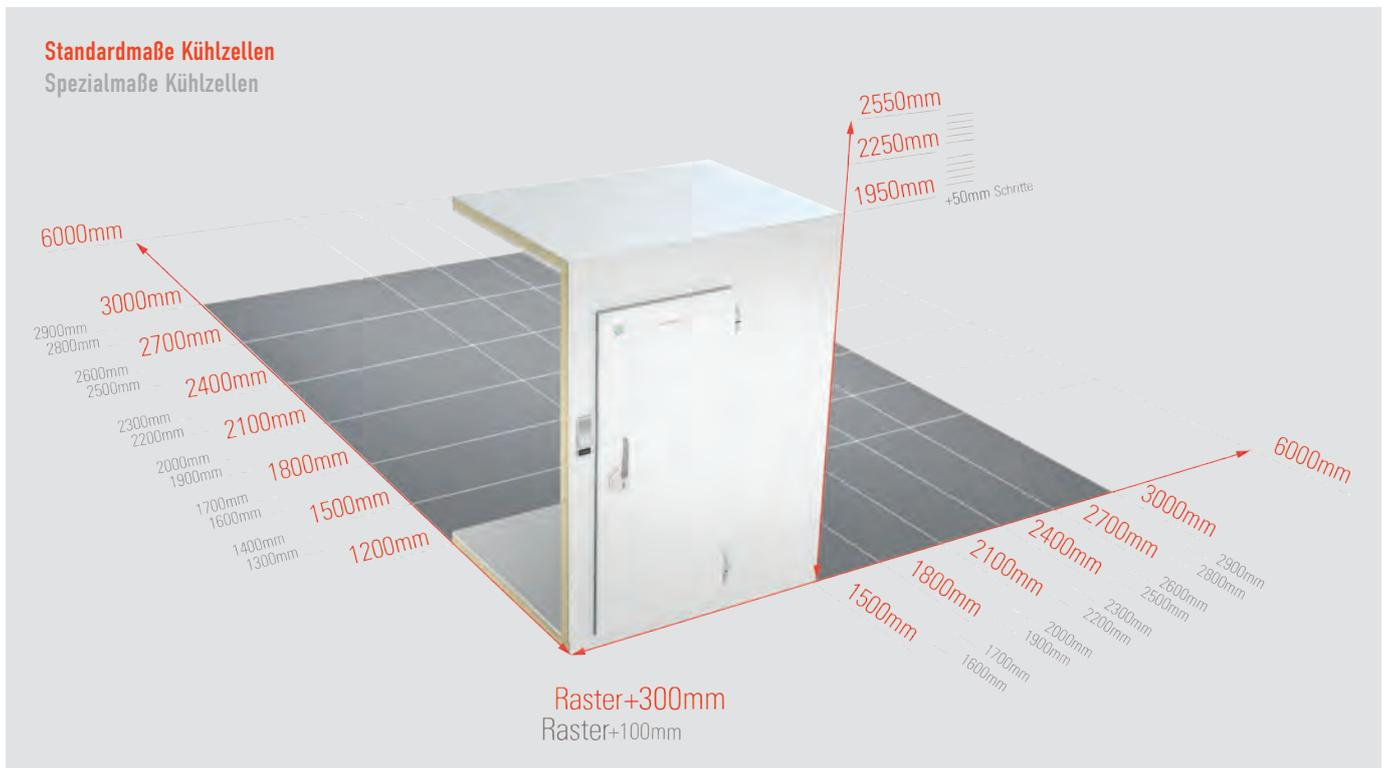
\*TectoCell Standard Plus Programm: 300 mm und 100 mm Raster (Maßanfertigung und größere Zellenabmessungen auf Anfrage).
